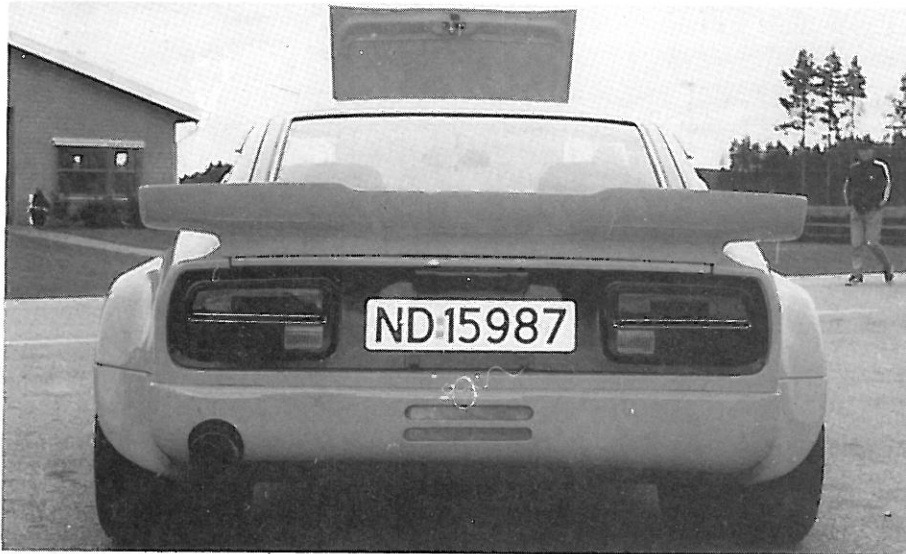
Eksempel på modernisert bil. Hjulene er bredere enn flatbygdene på Hadeland, skjermene er hentet fra Porsche 911 Turbo og støtfangerene/skjørtene er nyproduserte i glassfiber.
