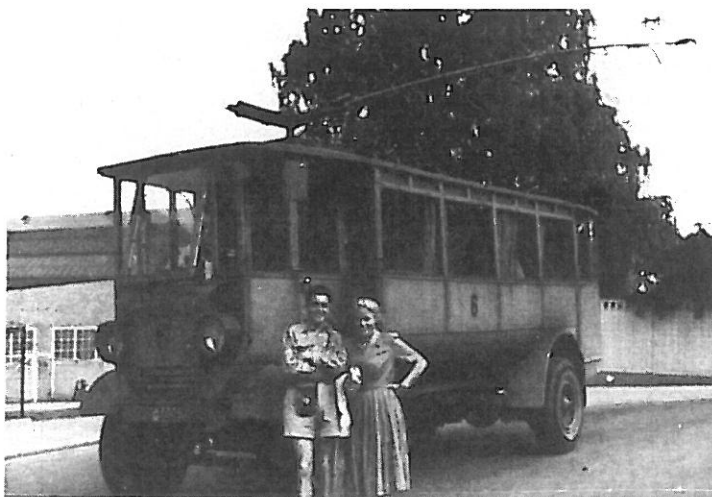
Drammen Kommunale trikk fotografert på Merket en gang i 40-årene. Trikken er egenprodusert av «Trikken A/S» tidlig i 1929. Motorene var av fabrikatet AEG.
